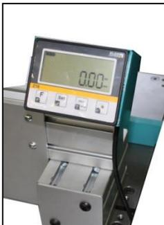
La segatrice SGC 650 può essere associata a qualsiasi rulliera di carico e scarico. Inoltre la macchina è anche disponibile nelle versioni con visualizzatore digitale dell'inclinazione e con movimentazione di tutte le angolazioni controllata tramite motore Brushless
