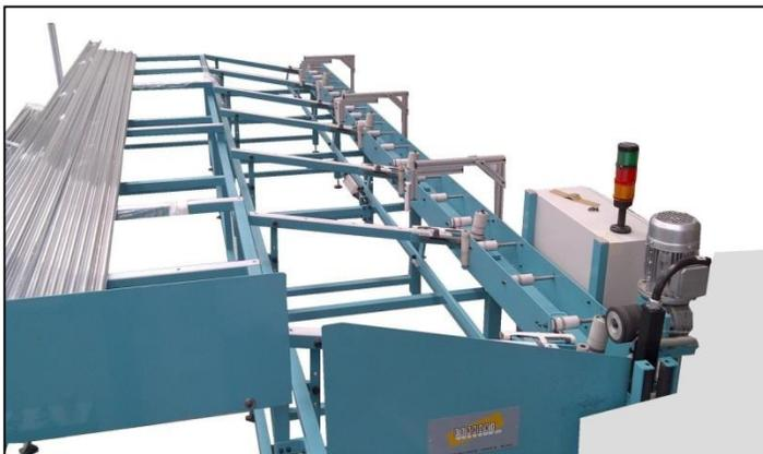
Le segatrici SGA possono essere accoppiate al magazzino di carico RC1, che consente di realizzare un impianto di taglio totalmente automatico garantendo lo scarico dello spezzone finale di barra e il carico della barra successiva da tagliare, riducendo al minimo l'intervento dell'operatore
