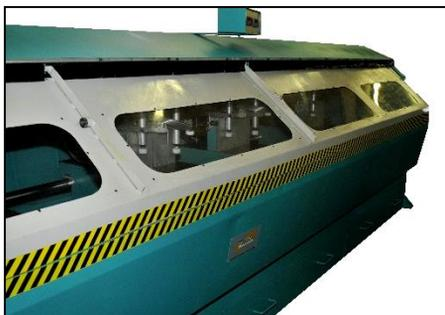
La SG4 può essere fornita con numerosi optional e personalizzazioni, come la lubrificazione minimale delle lame di taglio completa di serbatoio con sensore di livello, o il carter integrale totalmente insonorizzato
