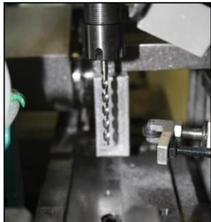
**TASTATORE AUTOMATICO DI INTEGRITA' UTENSILE:** ciascuna unità di lavorazione è dotata di un sistema automatico di integrità utensile che verifica che l'utensile sia integro prima di procedere alla lavorazione. La verifica avviene mentre l'utensile è ancora in rotazione evitando attese nel ciclo di lavorazione.
