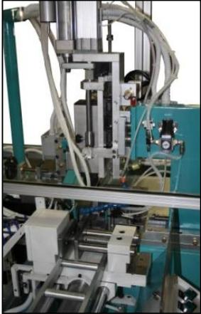
**UNITA' VERTICALE DI FORATURA:** l'unità verticale di foratura è equipaggiata con un elettromandrino ad alta velocità (fino a 18.000 giri/min) e con avanzamento a velocità regolabile (veloce in avvicinamento al pezzo, lento in lavorazione).
