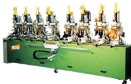
Le foratrici MultiDrill possono essere fornite con un numero variabile di testa di foratura in funzione delle esigenze del cliente. Nell'esempio è riportata una foratrice a 8 teste automatiche di foratura
