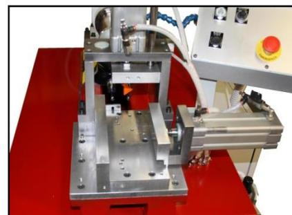
**Tavola portapezzo completa di bloccaggio pneumatico:** la tavola orizzontale è adatta al fissaggio di dime sagomate per il bloccaggio pneumatico dei profili.
