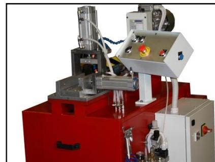
**Pulsantiera di comando laterale:** la pulsantiera è posizionata lateralmente per consentire il carico manuale del profilo da maschiare posizionandosi di fronte alla macchina.
