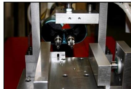
**Testa multipla ad interasse variabile:** adatta per la lavorazione dei profili strutturali o dei cilindri pneumatici in Alluminio che presentano passi di foratura costanti sulle sezioni di estremità.
