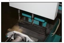
Interasse variabile: sono disponibili delle versioni con interasse variabile delle punte di foratura. La distanza è variabile o tramite una maniglia di manovra manuale o tramite u cilindro pneumatico
