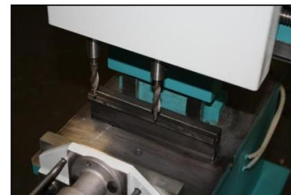
**Bloccaggio pneumatico del pezzo:** tutte le versioni delle foratrici BZMP sono dotate di bloccaggio pezzo pneumatico che garantisce un serraggio sicuro e preciso del pezzo.
